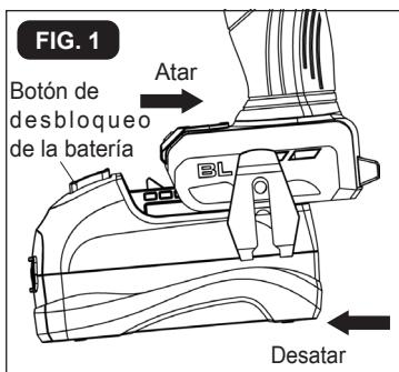
**AVISO:** Asegúrese de que el pestillo de la batería encaje en su sitio y que la batería en la herramienta inalámbrica antes de utilizarla.
