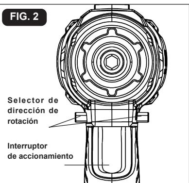
1. Para encender el atornillador de percusión, presione el interruptor de accionamiento.
