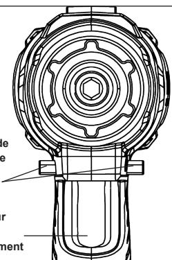
1. Pour allumer la visseuse à percussion, appuyez sur l'interrupteur de déclenchement.
