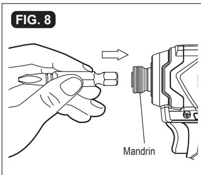
1. Verrouillez l'interrupteur de déclenchement sur la visseuse à percussion en plaçant le sélecteur de direction de rotation en position centrale.
