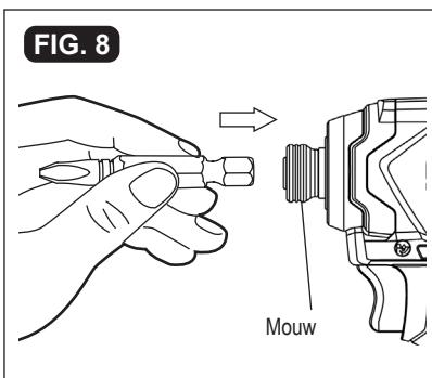
1. Vergrendel de trekkerschakelaar op de klopboormachine door de draairichtingselector in de middelste stand te plaatsen.
