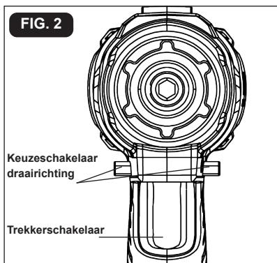
1. Om de klopboormachine aan te zetten, drukt u de trekker in.
