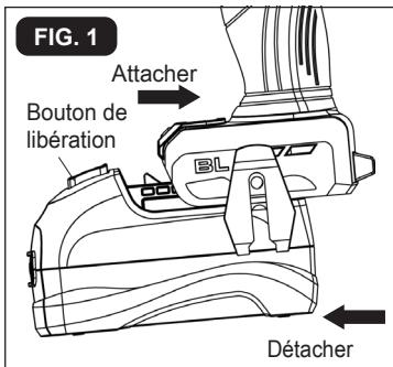
**AVIS :** Assurez-vous que le loquet du bloc-batterie s'enclenche et que le bloc-batterie est bien en place dans l'outil sans fil avant de l'utiliser.
