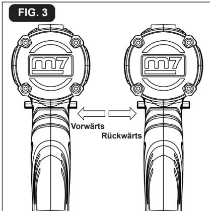
Die Drehrichtung ist umschaltbar und wird über einen Wahlschalter oberhalb des Triggerschalters gesteuert. Wenn sich der Schlagschraubendreher in der normalen Betriebsposition befindet: Positionieren Sie den Drehrichtungswähler links neben dem Werkzeug für die Vorwärtsdrehung; Positionieren Sie den Drehrichtungswähler rechts neben dem Werkzeug für die umgekehrte Drehung. Das Einstellen des Schalters auf die OFF-Position reduziert das Risiko eines versehentlichen Anfahrens bei Nichtgebrauch.
