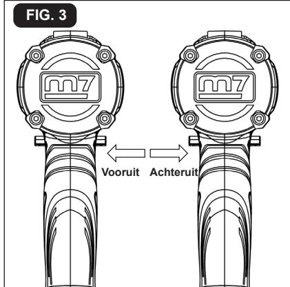
De draairichting is omkeerbaar en wordt geregeld door een keuzeschakelaar boven de trekkerschakelaar. Met de klopboormachine in de normale werkpositie: plaats de draairichtingselector links van het gereedschap voor voorwaartse rotatie; plaats de draairichtingselector rechts van het gereedschap voor achterwaartse rotatie. Door de schakelaar in de stand UIT (middenblokkering) te zetten, wordt de kans op onbedoeld starten verminderd, wanneer de motor niet in gebruik is.
